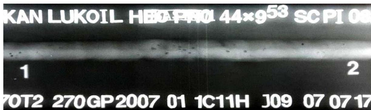
Рис. 6. Рентгеновский снимок образца сварного шва диаметром 1120 мм, полученный при гамма-радиографии
