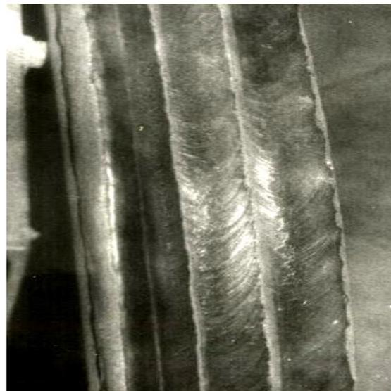
**Рис. Последовательность наложения валиков на поверхность обода колеса**
