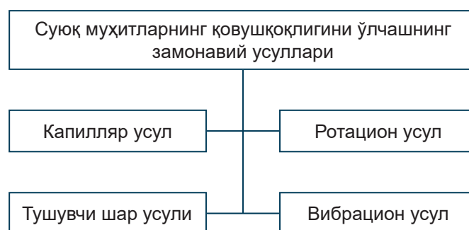
4-расм. Суюқ муҳитлар қовушқоқлигини ўлчашнинг замонавий усуллари классификацияси
