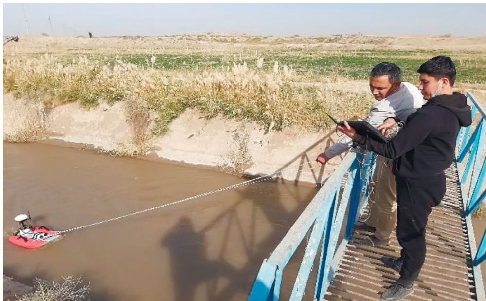
7-расм. “SonTek” S5 маркали доплер ёрдамида сув сарфини ўлчаш жараёни
