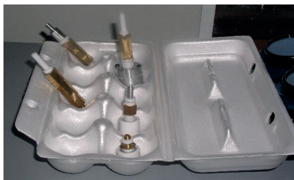
Рис. 2. Минирезонаторные кюветы с образцами
