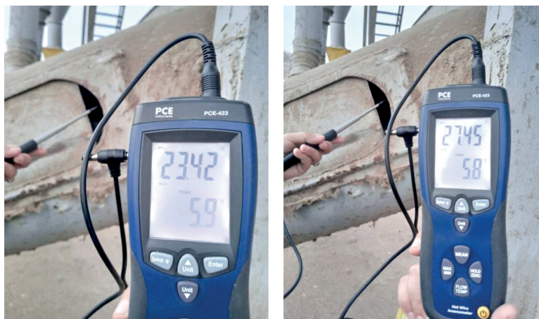
3-расм. Қувурдаги чанг ҳаво тезлиги ва ҳароратини “Термоанемометр PCE-423” маркали аппаратда ўлчаш жараёни
