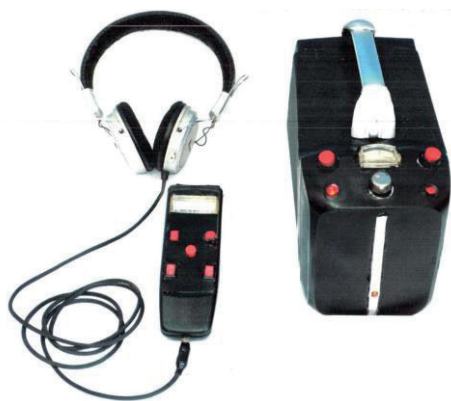
Рис. 3. Действующая модель прибора поиска подземных коммуникаций
