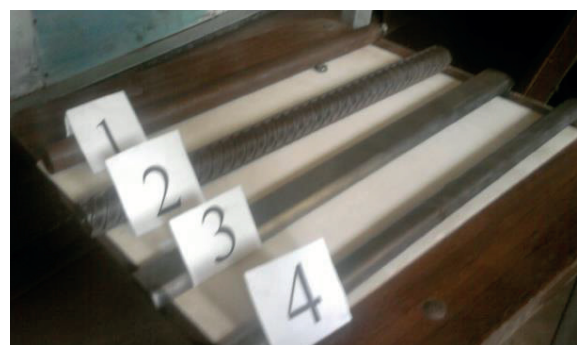
Рис. 3. Варианты исследуемых профилей колосниковых решеток
