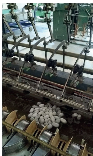
8-расм. Narada автомат пилла чувиш дастгоҳида юқори чизиқли зичликдаги хом ипак чувиш жараёни
