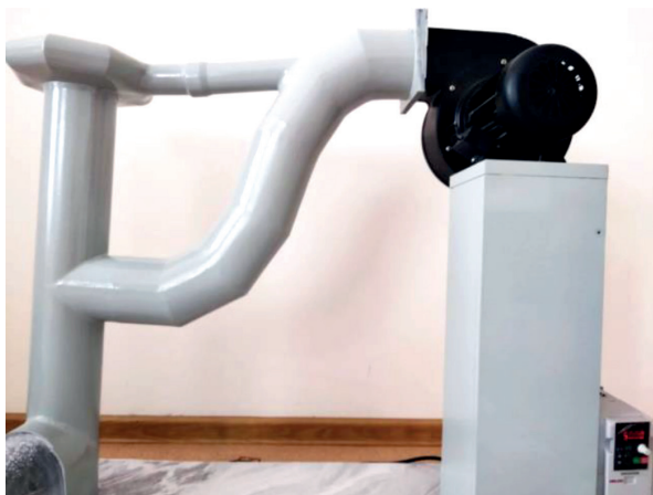
2-rasm. Shaxta stvoli va shamollatish kanali eksperimental imitatsion modeli
