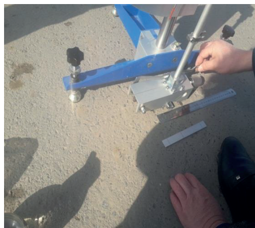
4-rasm. Avtomobil g'ildiragining yo'l qoplamasi bilan ilashish koeffitsiyentini aniqlash jarayoni
