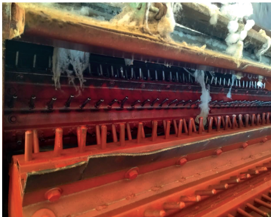
1) to‘rli yuza; 2) baraban bo‘g‘indagi rezina; 3) yoysimon uchli qoziqcha; 4) paxta bo‘lakchasi 7-rasm. Yoysimon qoziqcha bilan to‘r yuza orasidagi paxta bo‘lakchasining harakat sxemasi
