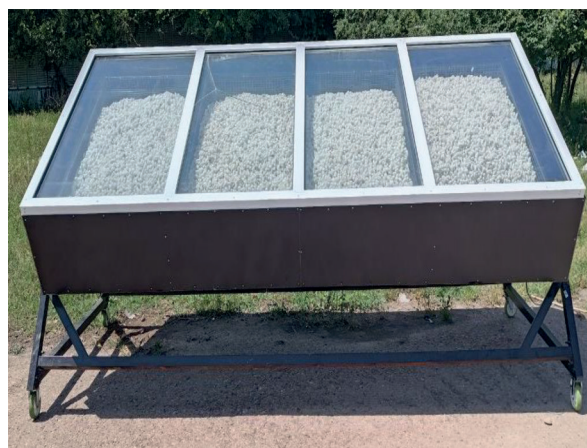
Рис. 1. Солнечная тепловая установка для замаривания коконов тутового шелкопряда
